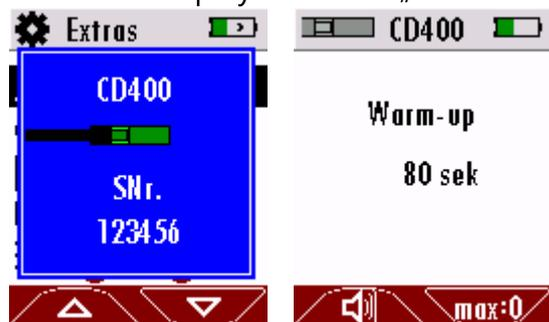
⇒ Nach dem Warm-up wechselt das Messgerät automatisch in den Messmodus.
